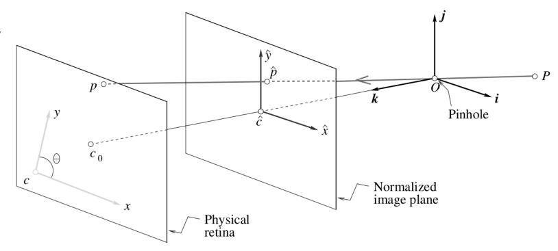
The skew parameter will be zero for most normal cameras.
